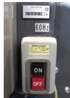
②押しボタンスイッチ 標準装備 ③アワーマーター 標準装備
